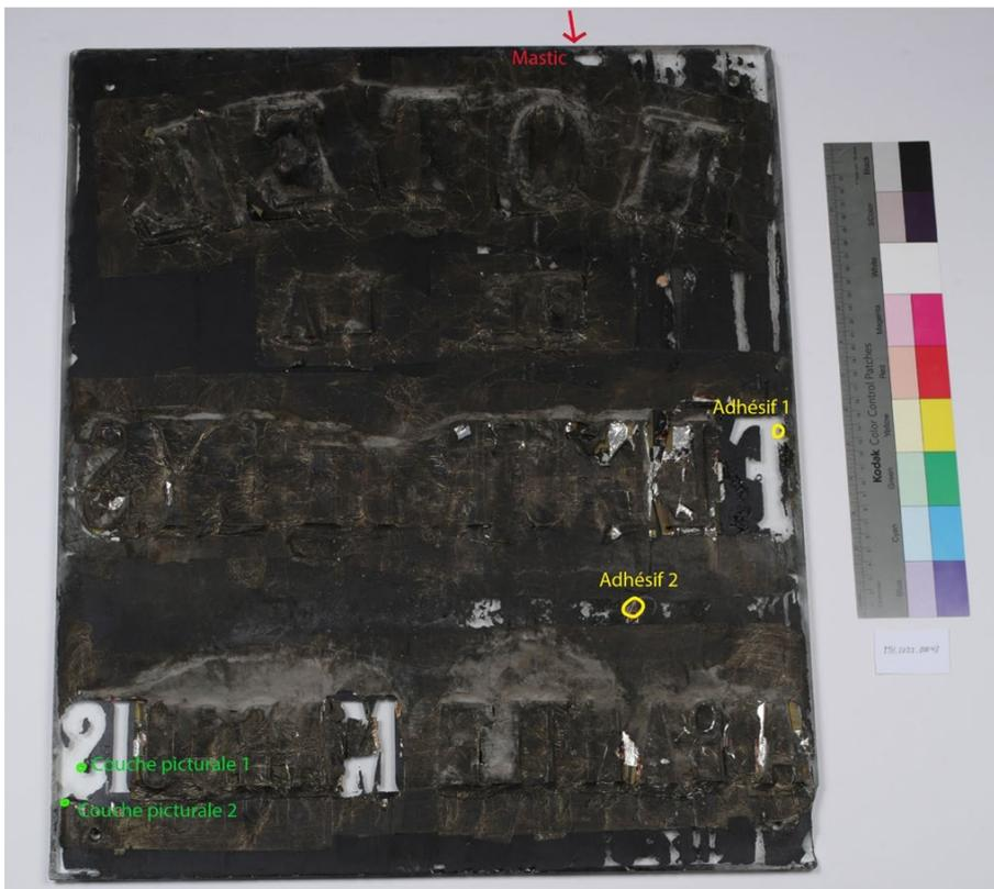
Figure 88 : Emplacements des prélèvements réalisés sur l'objet.
