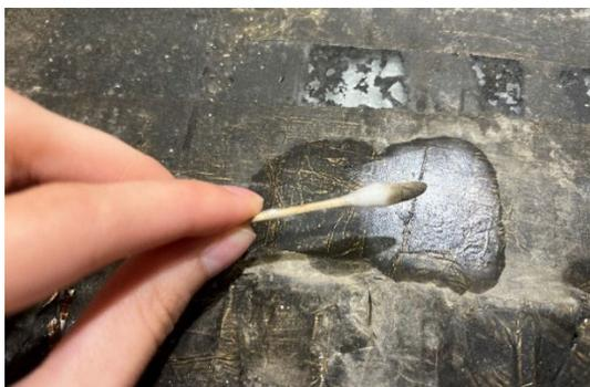
Figure 58 : Nettoyage avec une solution tamponnée et conductivité ajustée, hydrophobisation préalable de la surface.
