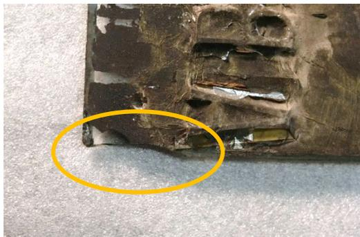
Figure 28 : Cassure sur le coin inférieur dextre, avec perte du fragment.
