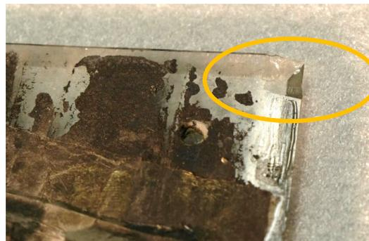
Figure 29 : Éclat visible sur le coin supérieur dextre avec ébréchures.
