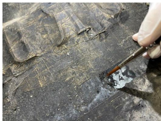
Figure 51 : Répartition des gouttelettes d'Aquazol® 200 sur les zones fragilisées.
