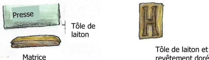
Figure 7 : Schéma présentant l'emboutissage et la dorure des lettres en laiton.
