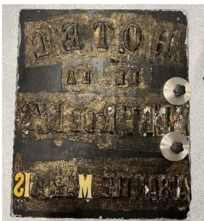
Figure 68 : Mise sous poids des lettres en laiton refixées.
