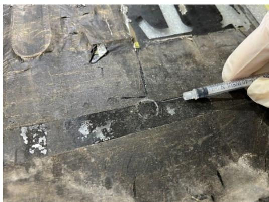
Figure 50 : Application de gouttelettes d'Aquazol® 200 à 3% dans l'eau déminéralisée.
